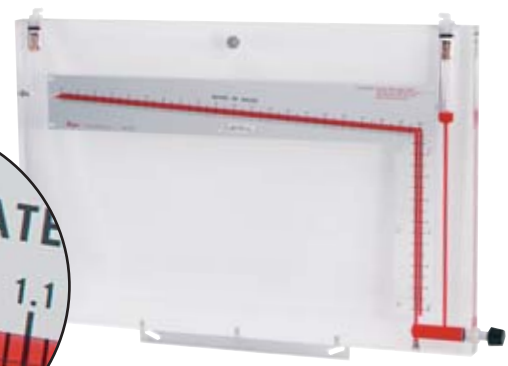
图. 8-1. 型号 424-10 倾斜—垂直压力计，0-10" 水柱范围。插图是倾斜刻度的实际尺寸。型号 424-5 是同样原理，水柱范围是 0-5"。
