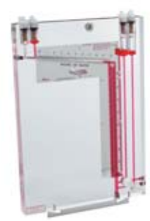
图. 8-2. 典型的 420 系列倾斜垂直压力计是 No.422-10 双柱压力计，0 到 10" 的水柱范围。也有单柱的型号供选择。设计功能和特点和 424 系列基本相同。它们都达到了 \pm 1\% 的精度，并特别适用于皮托管和用于流量测量及类似应用中。
