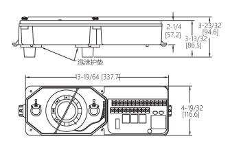
SL-2000系列风管烟雾探测器对于HVAC管道系统中存在的烟雾和燃烧产物的及早检测是极其重要的。它可用于许多不同类型的应用场合,包括商业楼宇,工业厂房和住宅。不仅可以在检测到烟雾时发出警报,还有继电器输出来关闭送风系统或鼓风机。SL-2000系列风管烟雾探测器具有技术人员方便使用的的"无需工具"功能,使安装和维护变得简单而高效。
